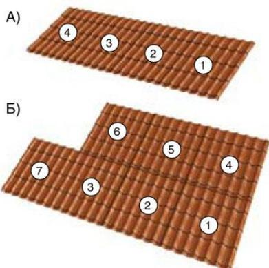
**Вариант1:** Укладка металлочерепицы по длине листа, которая равна длине ската кровли (рис. А)
