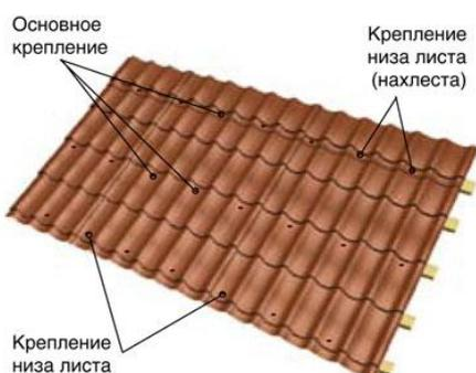
Листы металлочерепицы крепятся саморезами 4.8x28 (4.8x35) с цветной головкой и ЭПДМ-прокладкой. При этом цвет головки самореза подбирается под цвет листа металлочерепицы. Для надежного крепления их количество должно быть не менее 6-8 штук на 1 кв. м. металлочерепицы.
